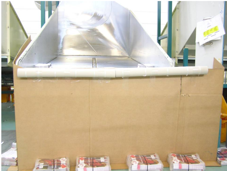
Kuva 5.6. Pienempi pyöreä rulla reunaan helpottaisi nostamista, kun lähetykset voidaan kääntää reunan yli.
